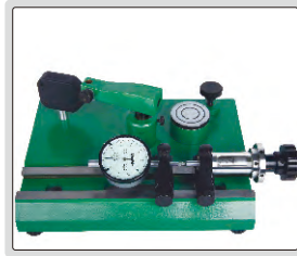
komparatör saatin doğrulunu kontrol etme (aralık 0-25mm)
