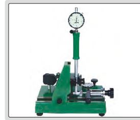
silindir komparatörün doğruluğunu kontrol etme (aralık 6-450mm)
