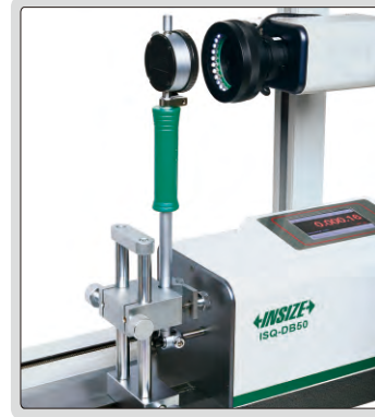
silindirik komparatör kontrol edilir
