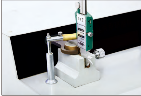
kumpasın en alt ağız yüzeylerinin lepleme ölçümü
